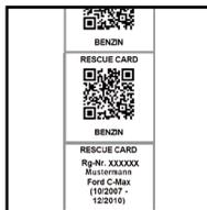
Überprüfen Sie, ob die auf dem QR-Etikettenstreifen angegebenen Fahrzeugdaten/Antriebsart mit Ihrem Fahrzeug übereinstimmen. Wir empfehlen einen Testscan mit einem Smartphone. Die Positionen der Etiketten sind Industriestandard und den Rettungskräften bekannt.
