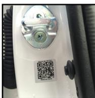
Das dritte QR-Etikett bringen Sie an der B-Säule der Fahrzeugseite an, die der Tankklappe gegenüberliegt.
